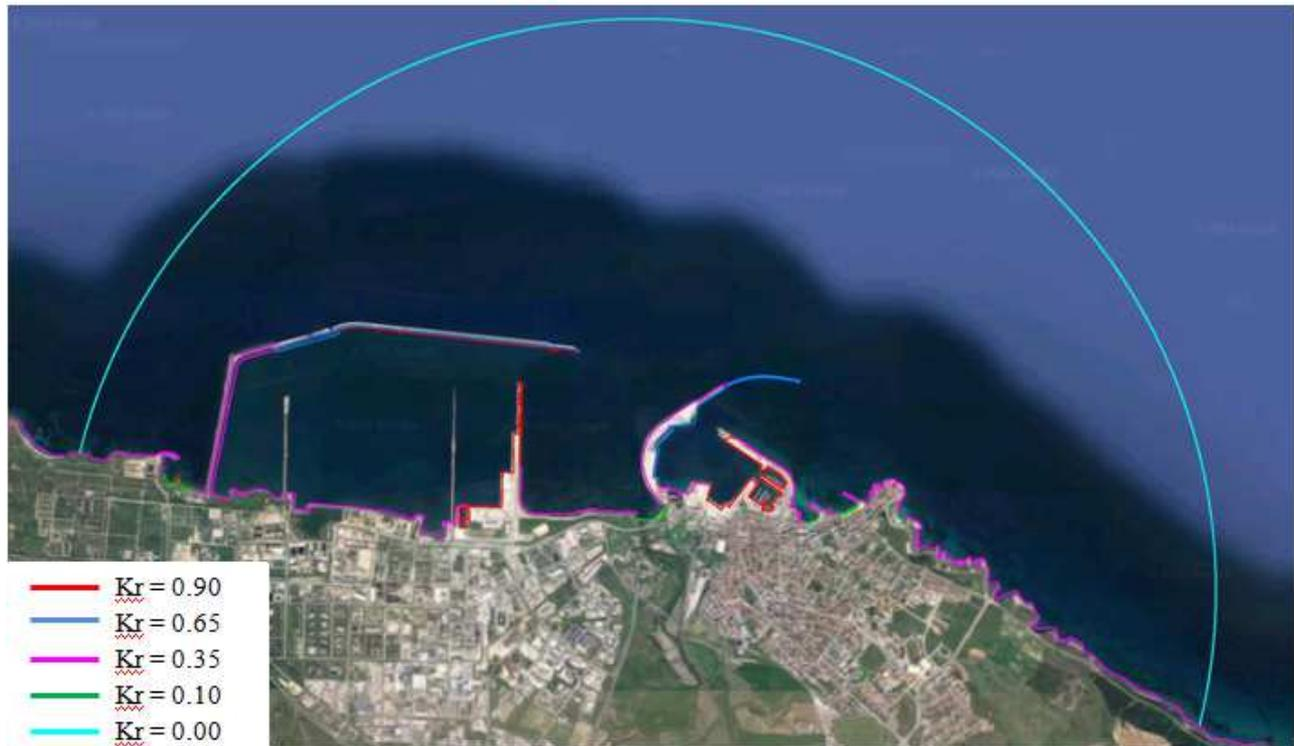
Figura 30. Configurazione di progetto: indicazione dei coefficienti adottati per le simulazioni
