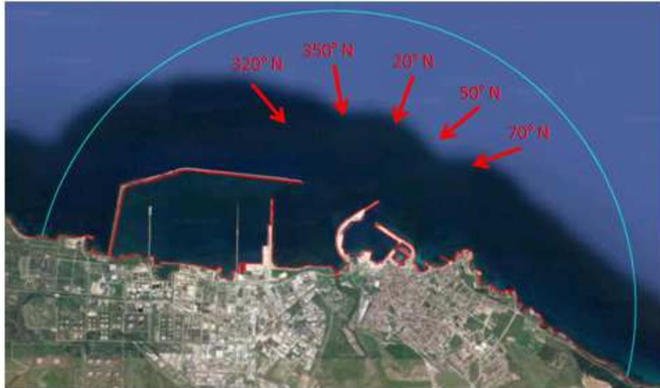
Figura 27. Dominio di calcolo con indicazione delle direzioni di provenienza delle onde
