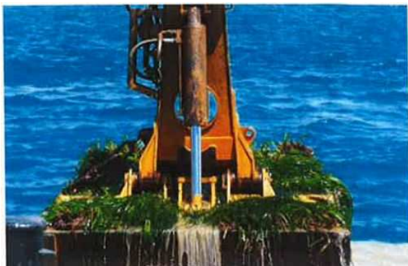
Figura 2 – Benna bivalve idraulica (da relazione Bedini 2014)
