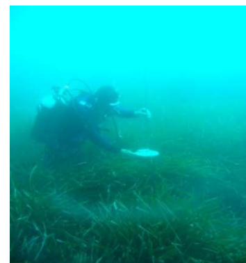
Figura4 – Misura della compattezza della matre con Penetrometro
