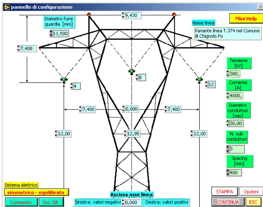
Figura 2: Configurazione dei sostegni NV, MV, PV.
