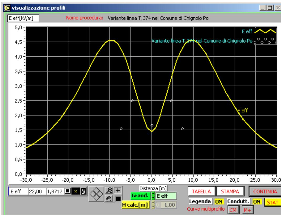
Figura 3: Andamento del campo elettrico calcolato cautelativamente a 1,5 m dal suolo nella configurazione dei sostegni NV - MV - PV.
