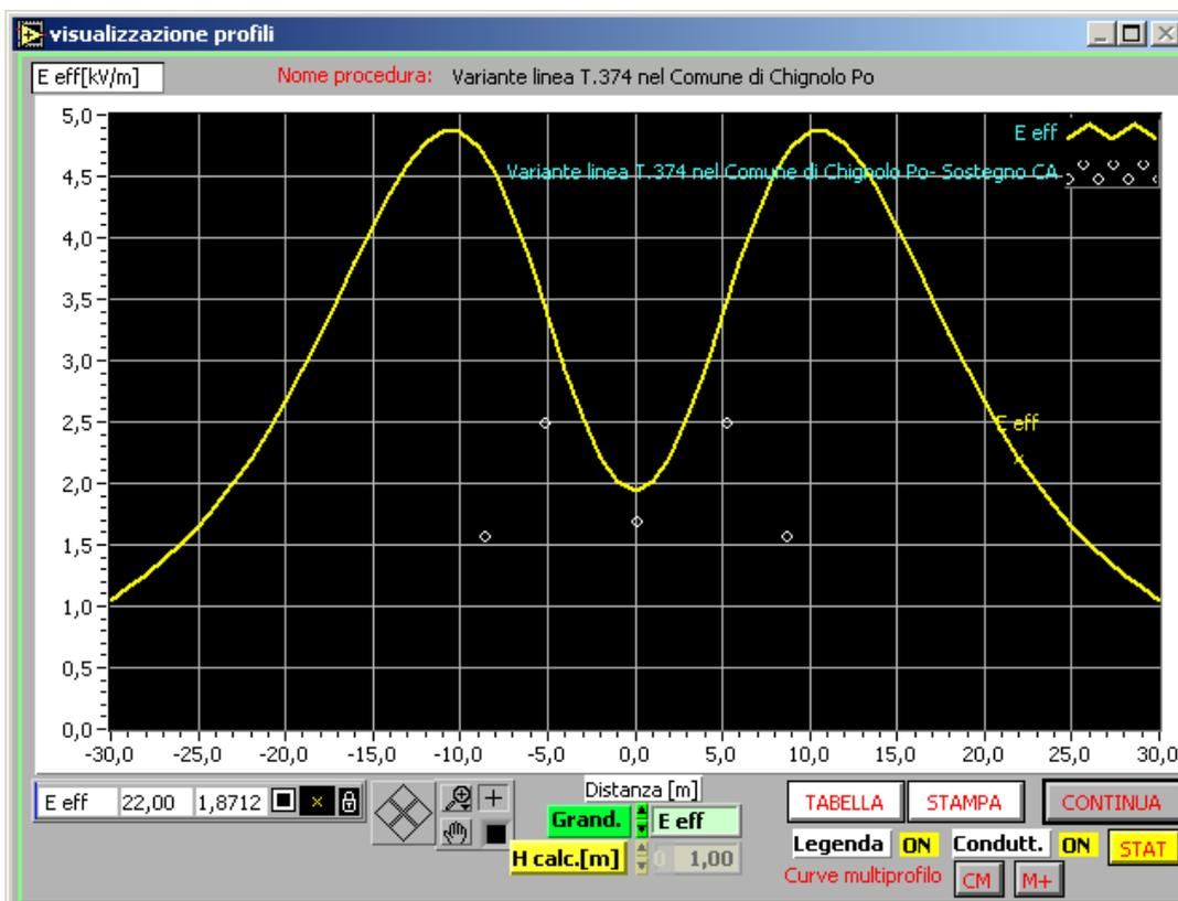
Figura 5: Andamento del campo elettrico calcolato cautelativamente a 1,5 m dal suolo nella configurazione dei sostegno CA.
