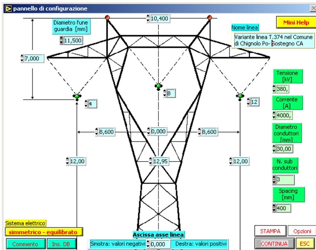
Figura 4: Configurazione del sostegno CA.
