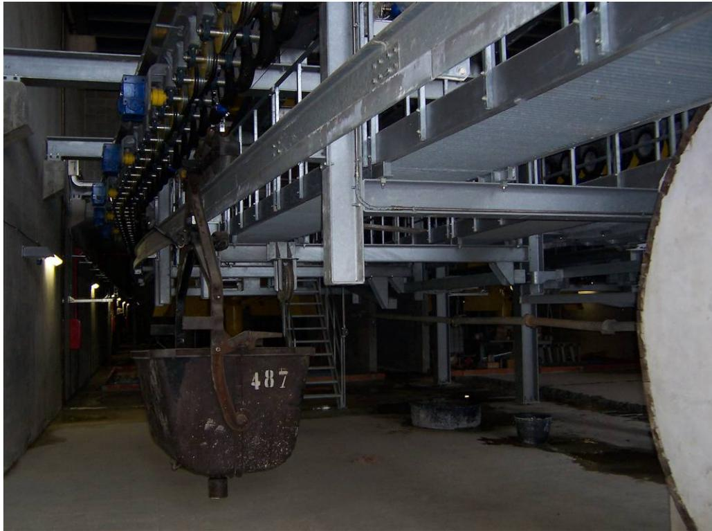
Il carico e lo scarico del materiale dai vagoni avviene automaticamente, fatta eccezione per i materiali speciali per i quali esiste un'apposita corsia di rallentamento e sgancio per permetterne lo scarico in sicurezza
