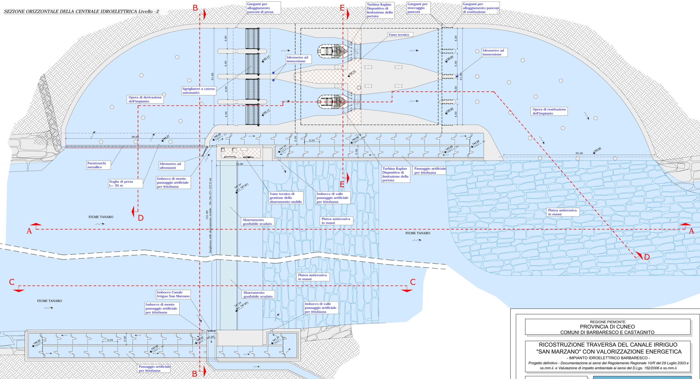
SEZIONE ORIZZONTALE DELLA CENTRALE IDROELETTRICA Livello -1
