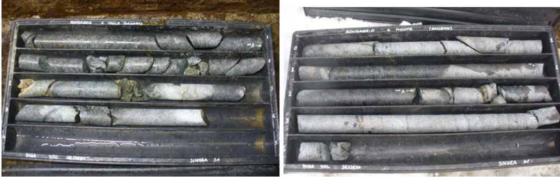
Foto 6.4– Carotaggi per installazione estensimetri. Sin: lato valle. Destra: lato monte
