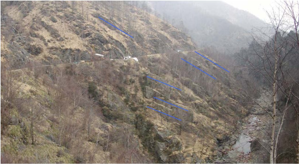
Foto 6.1– Versante sinistro con evidenziati i principali sistemi di discontinuità
