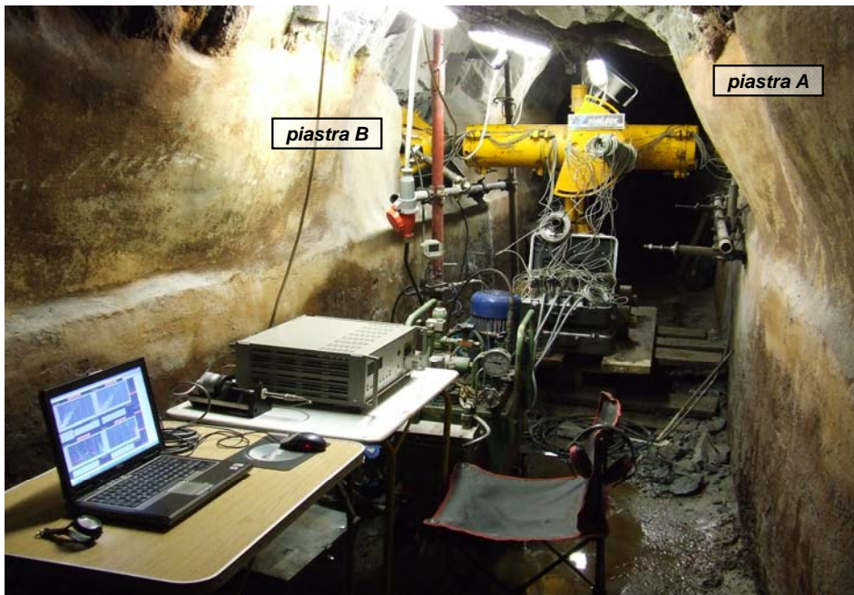
Fotografie dell'attrezzatura durante la prova (in basso con il sistema di acquisizione dati)
