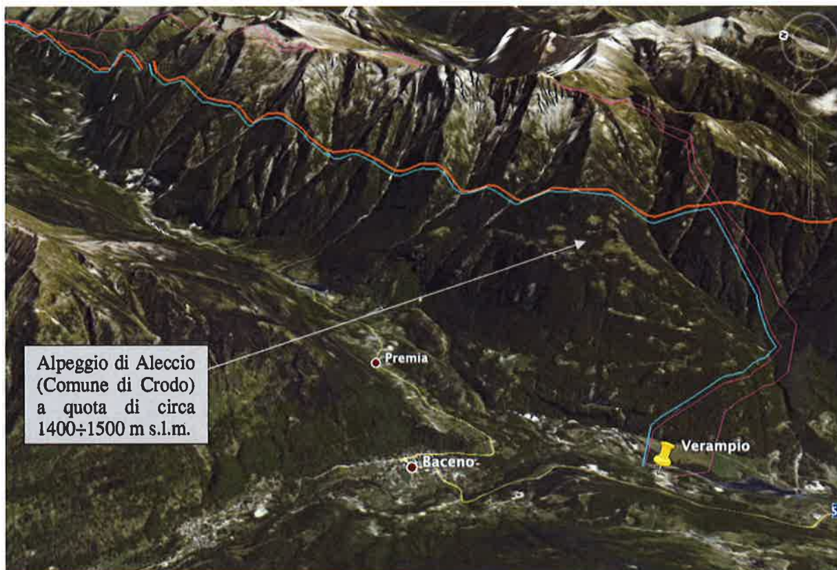
Figura 6: simulazione tridimensionale di dettaglio (nei Comuni di Premia e Crodo) della proposta di varianti sostenibili ai tracciati proposti da TERNA relativi alle linee a 220 kV e 380 kV.
