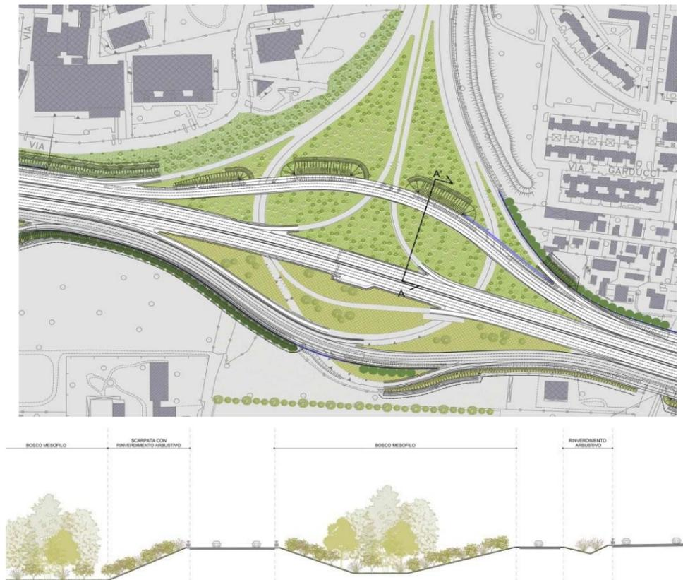
Figura 4-16 Schema planimetrico e sezioni degli interventi di riqualificazione ambientale delle aree intercluse (elaborazione LAND ©)
