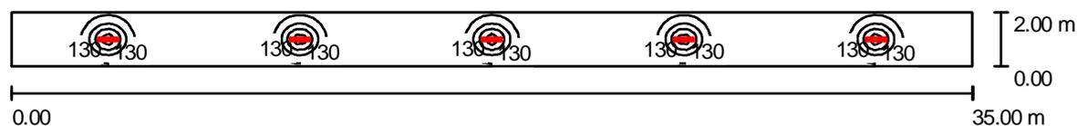
Altezza locale: 3.200 m, Altezza di montaggio: 3.200 m, Fattore di manutenzione: 0.80
