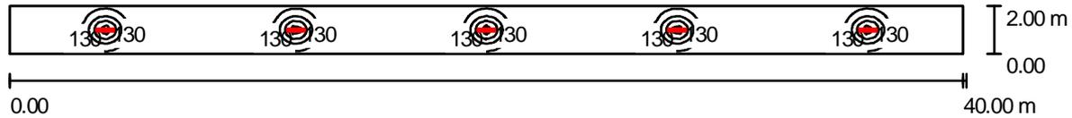
Altezza locale: 3.200 m, Altezza di montaggio: 3.200 m, Fattore di manutenzione: 0.80
