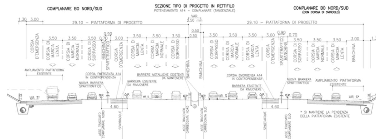
Figura 4-13 Sezione tipo corrente (fonte: Progetto definitivo – Relazione generale)
