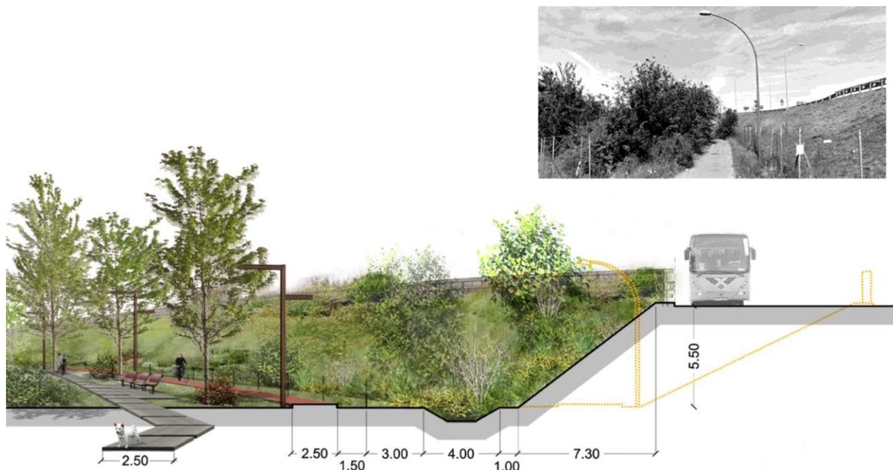
Figura 10: Tipologico percorso - sezione (via Zambeccari)
