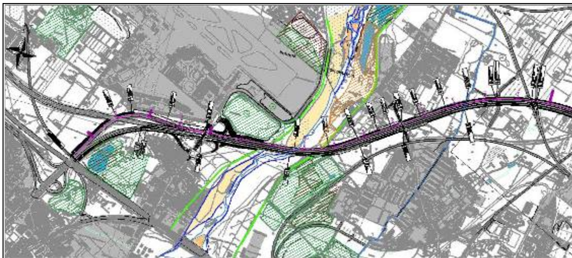
Fig.20 - Stralcio Tavola 1/1 Passante di Mezzo della Planimetria geomorfologica, al centro della foto il tracciato del passante di mezzo (da base topografica CTR modif.).
