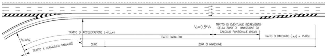
*Figura 4 – Schema planimetrico corsia di immissione*
