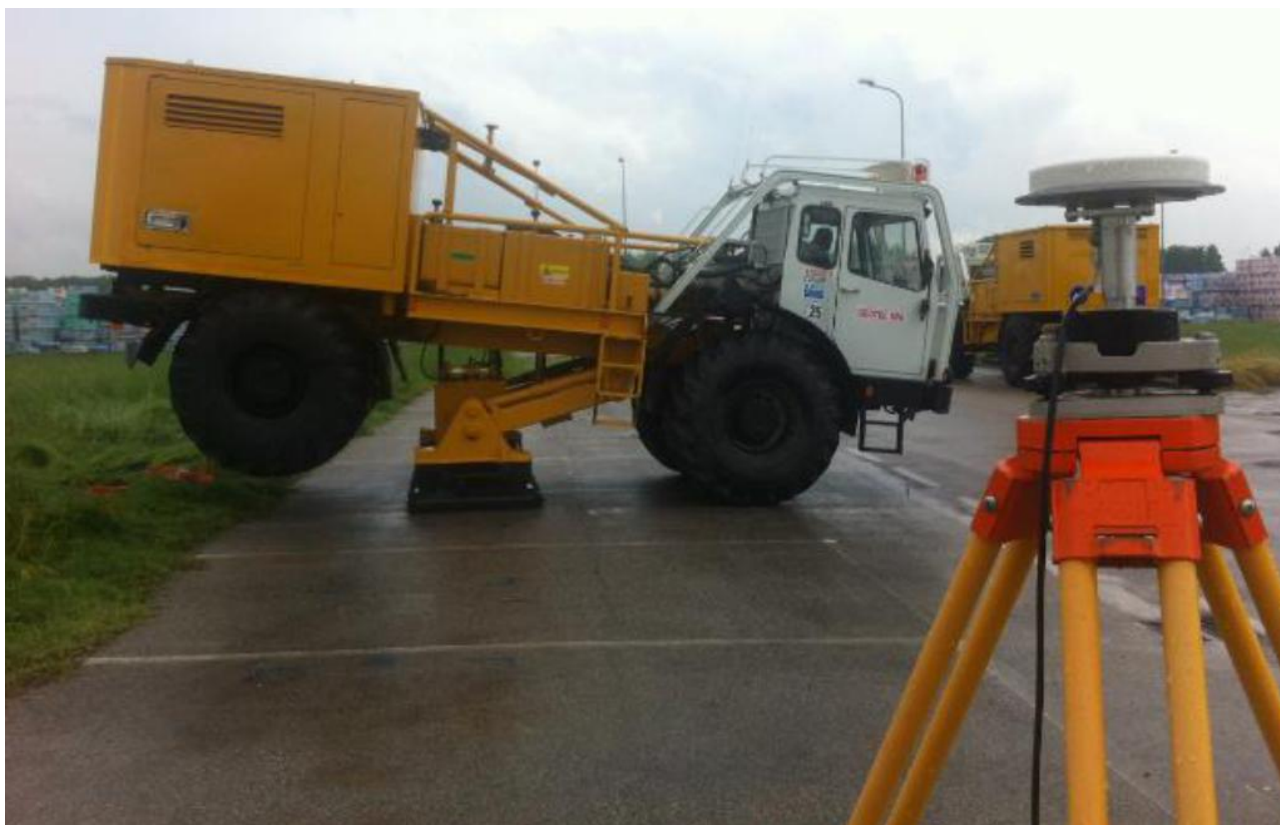
Figura n. 23: mezzo a vibroseis utilizzato durante la prova sperimentale
