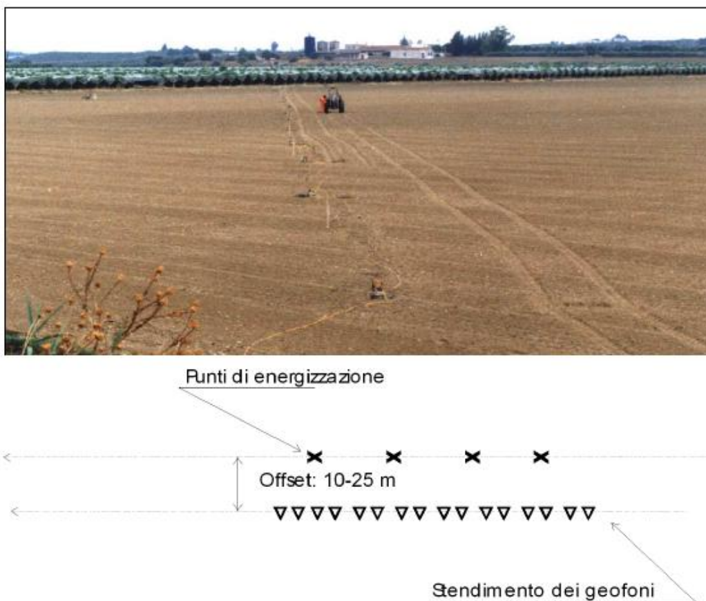
Figura n. 1: Esempio di stendimento che prevede una linea di stendimento con gruppi di 16 geofoni ed una linea di energizzazione distante dalla prima 10-25 m; nella foto si vede un Vibroseis montato su trattore agricolo che procede sul campo arato, parallelamente alla linea dei geofoni, con offset di ca. 6 m
