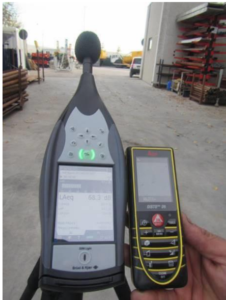
Misura trasversale allineamento vibratori: 60 m - 68.3 dB
