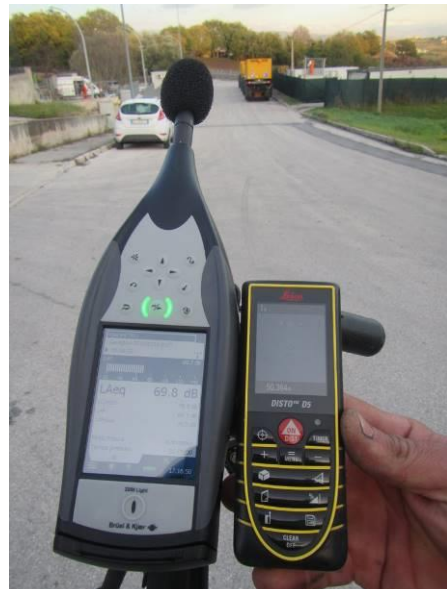
Misura longitudinale allineamento vibratori: 50 m – 69.9 dB
