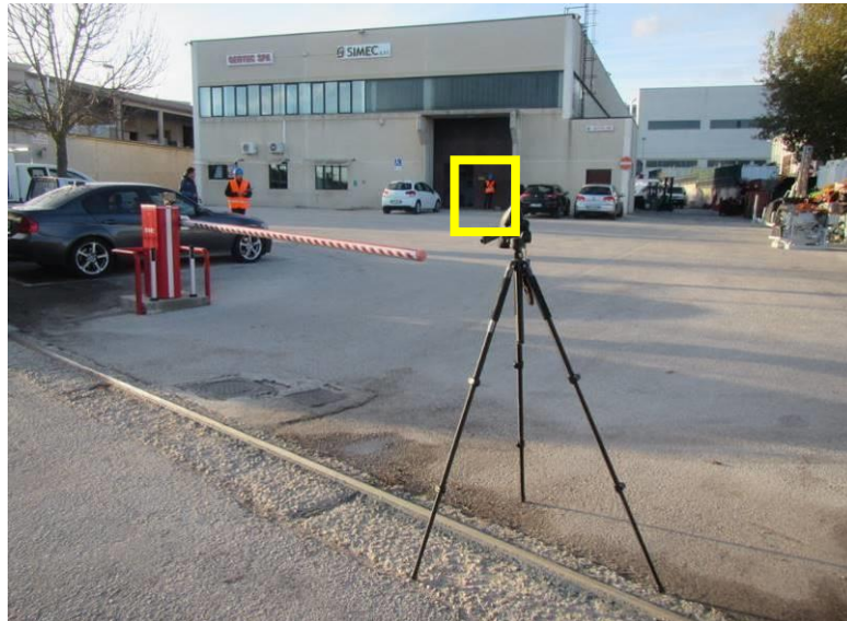
REALIZZAZIONE MISURE VIBROMETRICHE (RIQUADRO GIALLO)
