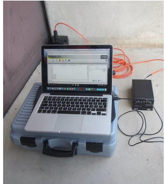
Misura trasversale allineamento vibratori: 10 m - PAVIMENTO INDUSTRIALE
