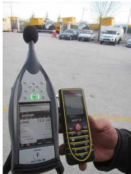
Misura trasversale allineamento vibratori: 40 m - 73.0 dB
