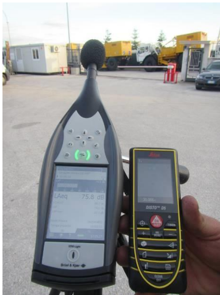
Misura trasversale allineamento vibratori: 30 m - 75.8 dB
