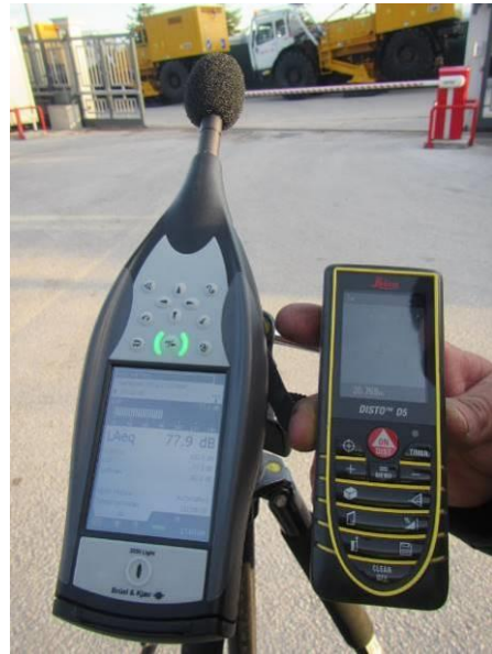
Misura trasversale allineamento vibratori: 20 m - 77.9 dB
