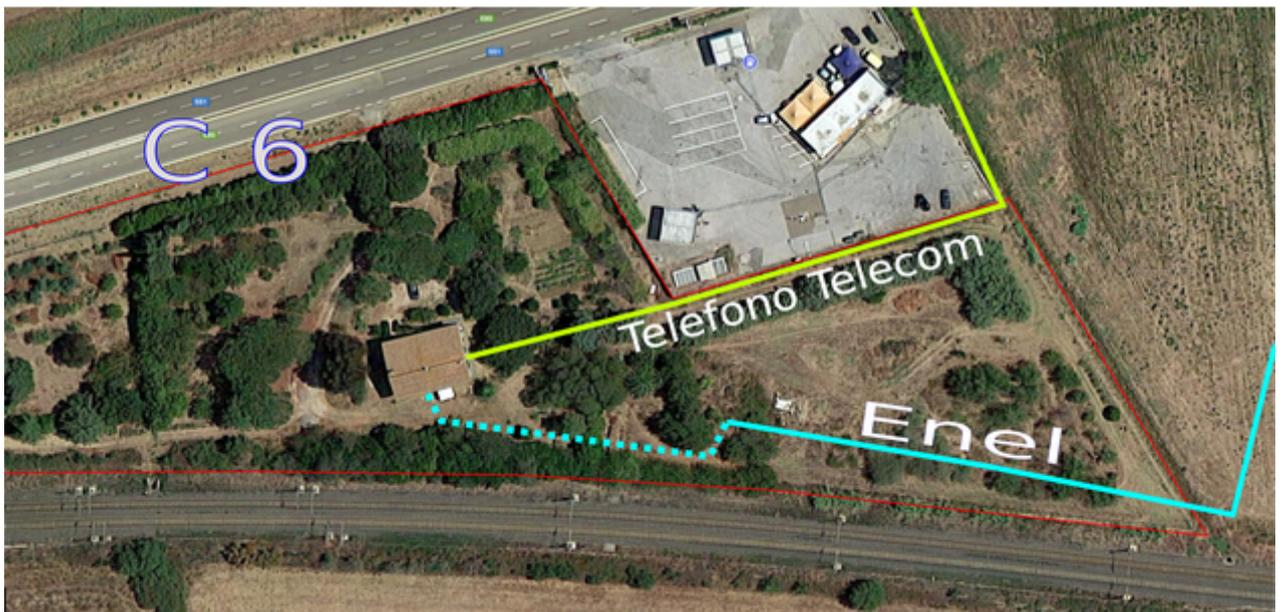
Nell'immagine C6 vengono evidenziate la linea Telecom, completamente su pali in legno, e la linea Enel, su pali in cemento la parte a tratto continuo ed interrata quella con linea tratteggiata.
