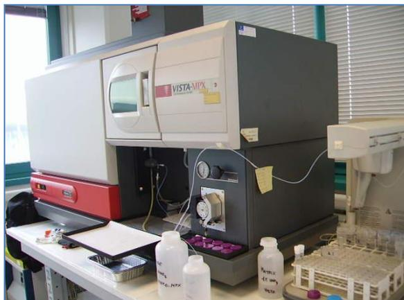
**A1- VIII Analisi BTEX - Spettrofotometro di massa quadrupolare
