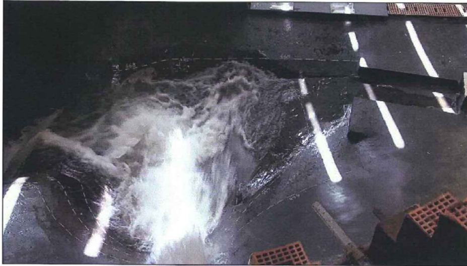
Fig. 10/3 – Modello fisico (configurazione di progetto). Vista del bacino di impatto per la portata 95.5 \text{ m}^3/\text{s} .
