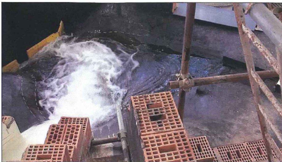
Fig. 10/1 – Modello fisico (presenza del restringimento in alveo). Vista del bacino di impatto per la portata 95.5 \text{ m}^3/\text{s} .
