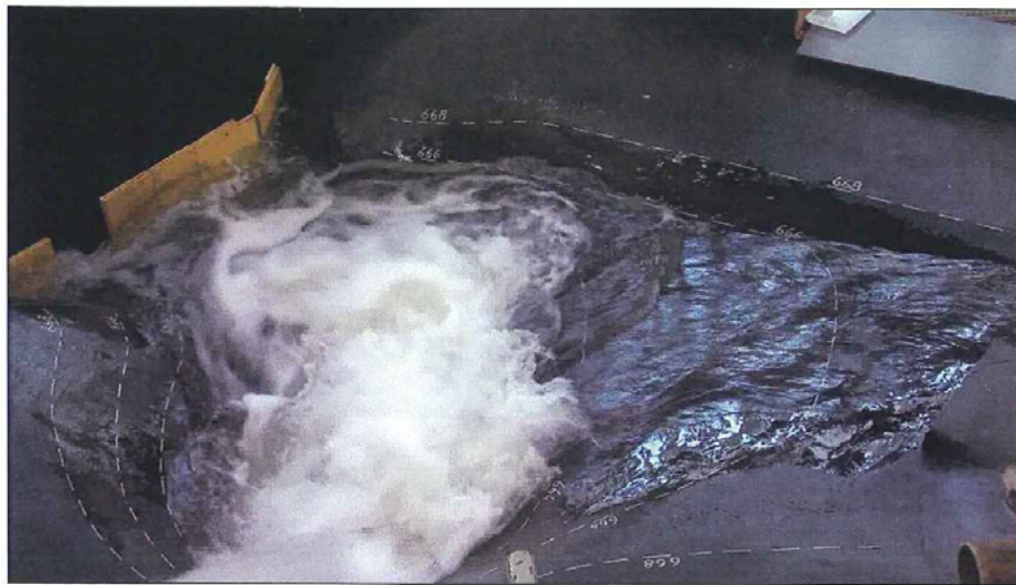
Fig. 10/2 – Modello fisico (presenza del restringimento in alveo). Vista del bacino di impatto per la portata 75 \text{ m}^3/\text{s} .
