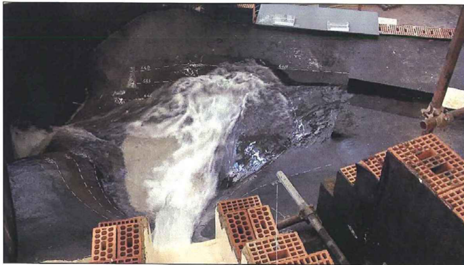
Fig. 10/4 – Modello fisico (configurazione di progetto). Vista del bacino di impatto per la portata 75 \text{ m}^3/\text{s} .
