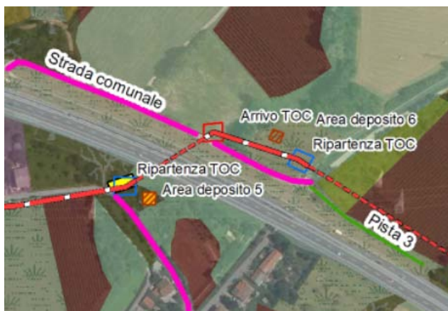
Fig. 4.5: Particolare area intervento in sponda sin e presso autostrada
