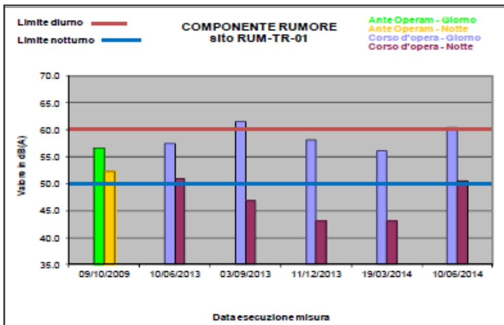
Relativamente a tale criticità CTE riferisce che in prossimità del ricettore sono attive lavorazioni diurne, ossia passaggio mezzi d'opera (camion, veicoli leggeri, botti, gru, rullo), nell'area di lavoro e lungo le piste per la stesa e compattazione dell'ultimo strato di binder del rilevato autostradale TEEM e per il completamento del montaggio delle barriere. Sono presenti anche componenti dovute al rumore di fondo della SP Rivoltana.
