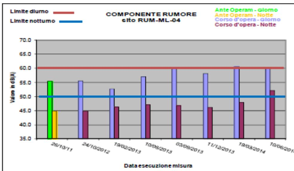
A seguito dei superamenti sono state inviate le segnalazioni di anomalia, in cui sono descritte le seguenti attività di cantiere: passaggio di veicoli di cantiere lungo la nuova viabilità di servizio e nell'area di lavoro del cantiere CI02 (botti, pala cingolata, escavatori, camion). Impianti di betonaggio e di vagliatura attivi.
