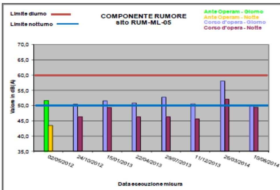
A seguito dei superamenti è stata inviata la segnalazione di anomalia, in cui viene descritta la seguente attività di cantiere passaggio di veicoli pesanti (camion, escavatori, pala cingolata, pala gommata), inerenti la movimentazione dei materiali inerti per la realizzazione del nuovo tracciato TEEM e dello svincolo di Melzo, cava di prestito di Melzo/Pozzuolo attiva, con draghe e nastri vaglianti in funzione per l'estrazione di materiali ghiaiosi.
