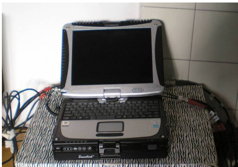
Figura 1 - Analizzatore Sinus mod. Soundbook S/N 6255
