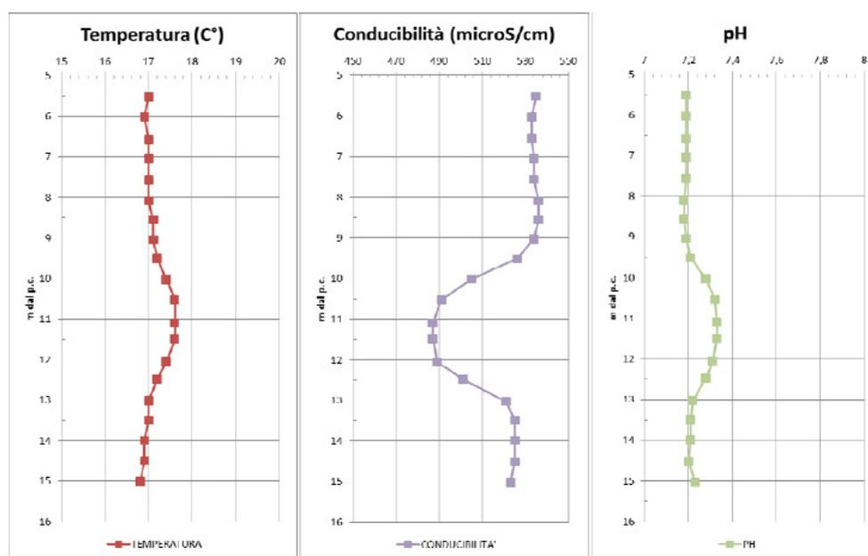
In condizioni post spurgo i parametri monitorati lungo la verticale, nell'intorno degli 11 m di profondità dal p.c. risultano analoghi ai valori registrati al termine del campionamento dinamico attraverso il rilievo standard dei parametri chimico fisici, a profondità superiori ed inferiori assumono valori più simili alle condizioni pre-spurgo.
