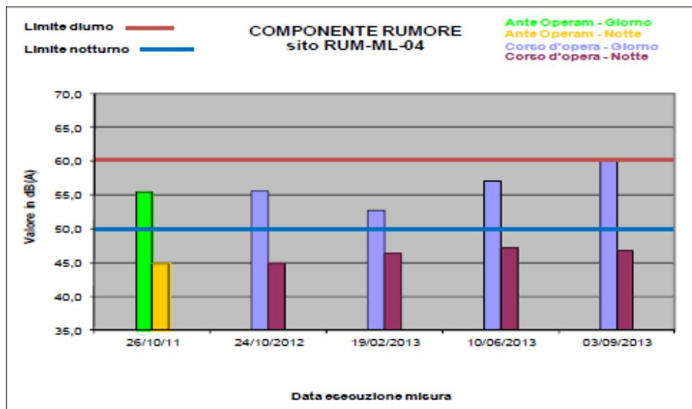
A seguito dei superamenti è stata inviata la segnalazione di anomalia, in cui viene descritta la seguente attività di cantiere: (RI004) Formazione del rilevato con materiale terroso da sottoporre a trattamento a calce e/o cemento, passaggio di mezzi di cantiere lungo la pista. Il ricettore è inoltre esposto al cantiere industriale CI02 attivo nel periodo interessato dalla misura (impianti di betonaggio e di vagliatura).
