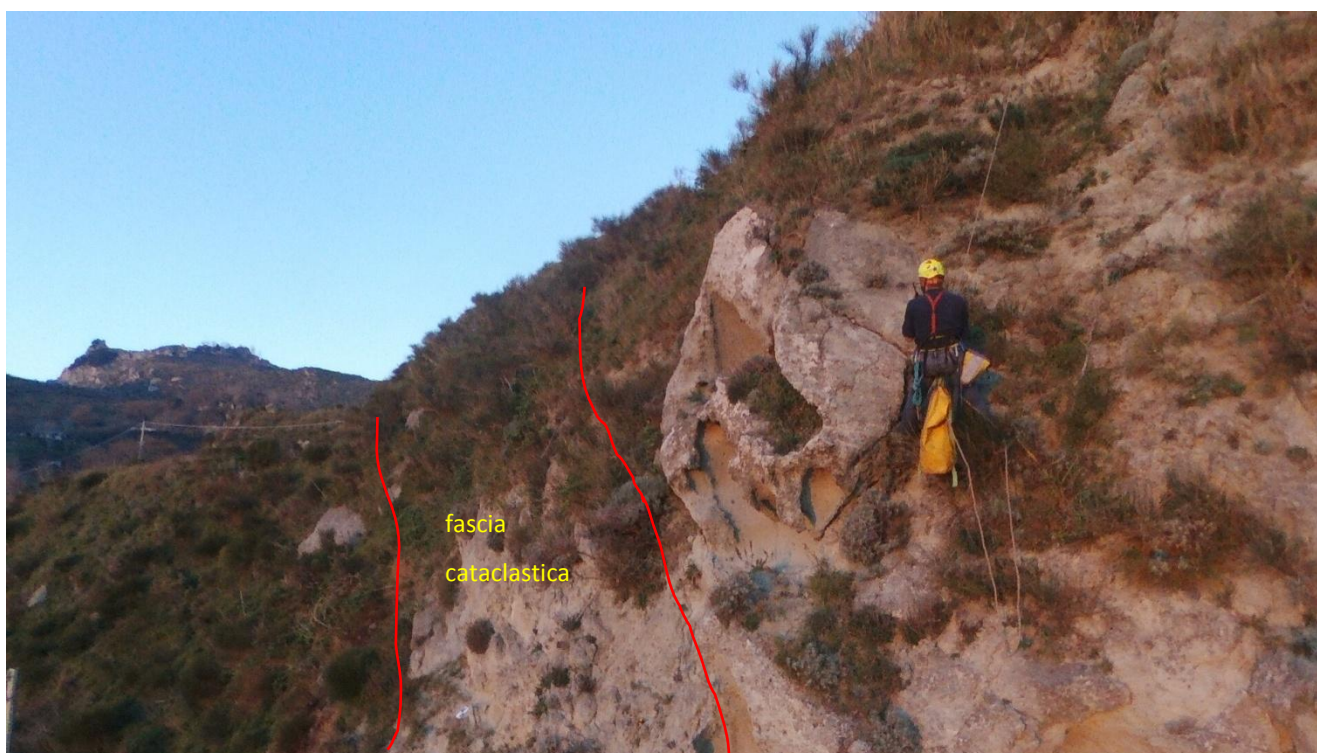
Figura 30: Area in equilibrio precario dove si individuano un masso in ribaltamento e un cuneo di dimensioni pluri-decimetriche in scivolamento, scalzati per effetto di erosione eolica spinta. Si evidenzia, inoltre, nella parte destra della foto una zona particolarmente alterata e fratturata, probabilmente ascrivibile ad una fascia cataclastica ai piedi del versante
