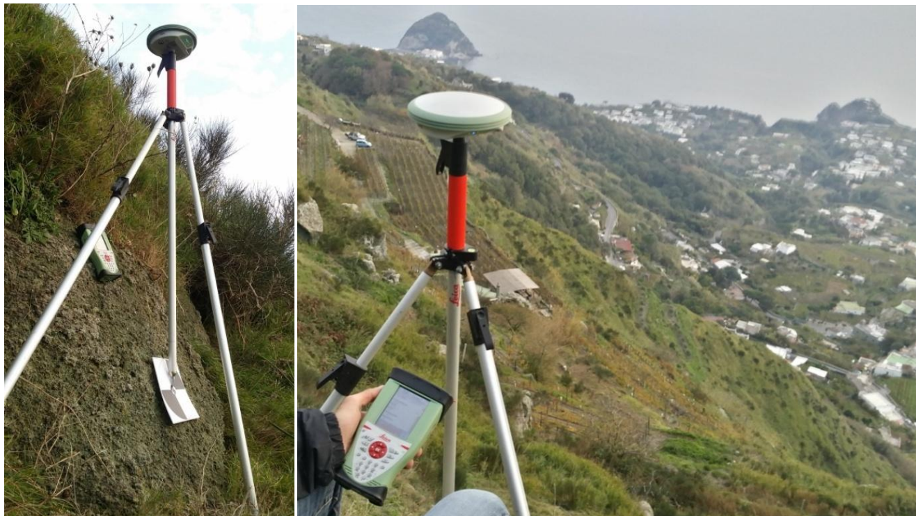
Figura 3: Fase di rilievo geodetico mediante GNSS in modalità statico-veloce, per la georeferenziazione dei modelli fotogrammetrici.
