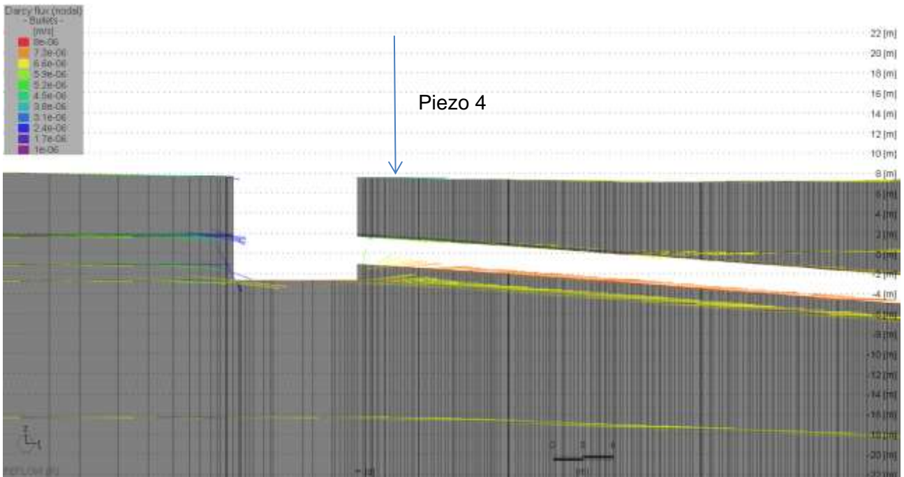
Figura 48: Direzioni e campo di velocità in una sezione trasversale al tracciato del microtunnel
