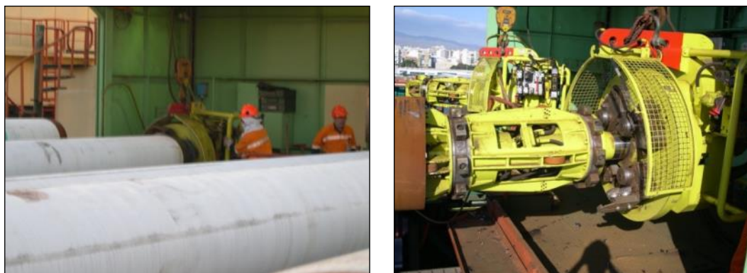
Figura 5 - Stazione di cianfrinatura e macchina di cianfrinatura a bordo della Castoro Sei
