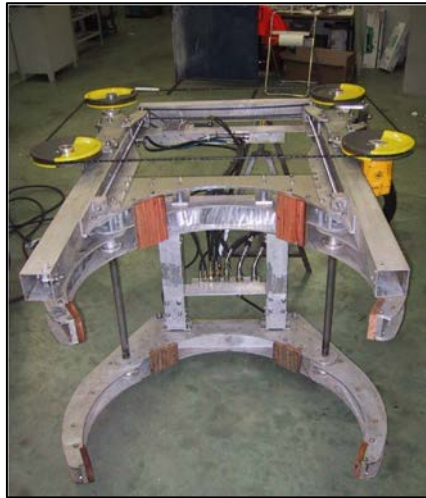
Figura 12 - Tipico strumento da taglio con filo diamantato
