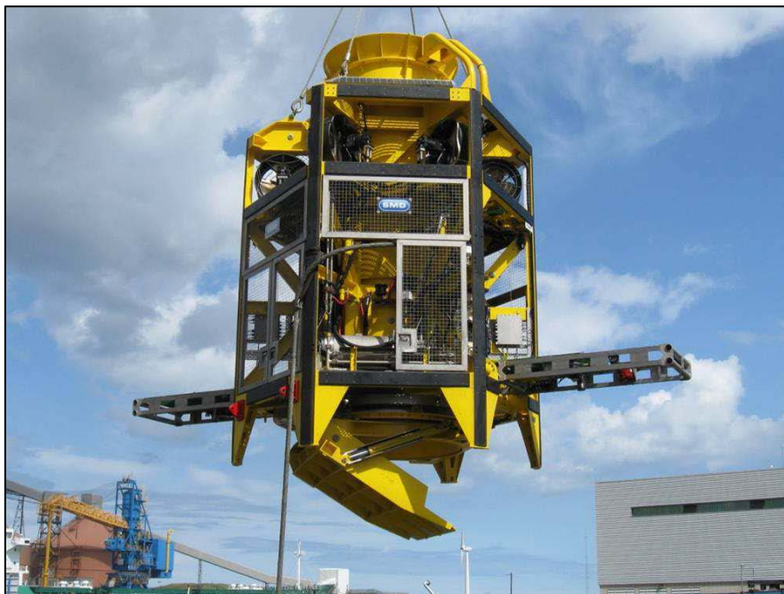
Figura 51 - Tubo di caduta rocce con ROV (FPROV)
