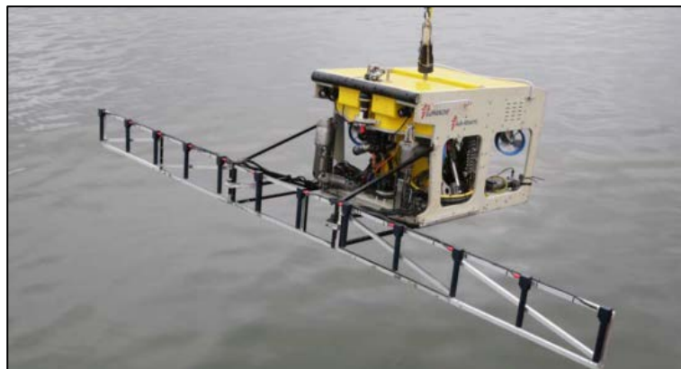
Figura 15 - Innovatum Smart Search da 12 elementi montato su ROV
