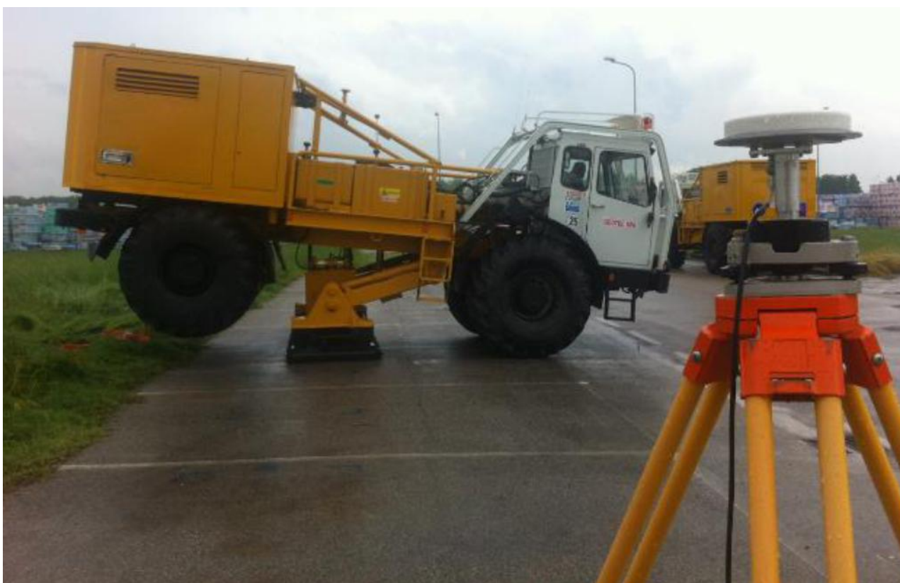
Figura 14 - mezzo a vibroseis utilizzato durante la prova sperimentale
