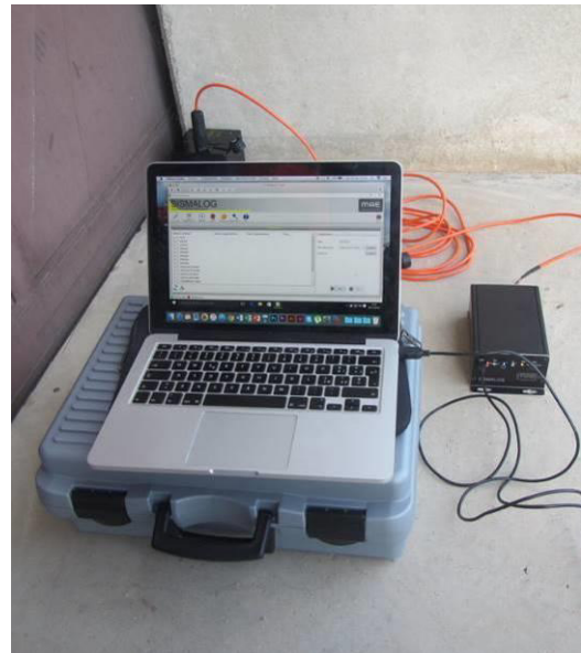
Misura trasversale allineamento vibratori: 10 m - PAVIMENTO INDUSTRIALE
