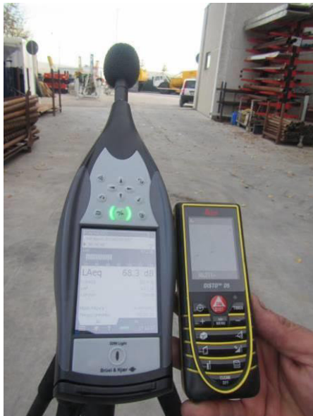
Misura trasversale allineamento vibratori: 60 m - 68.3 dB
