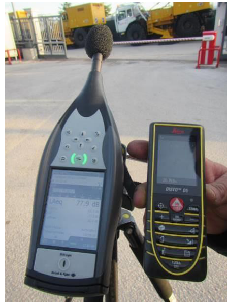
Misura trasversale allineamento vibratori: 20 m - 77.9 dB
