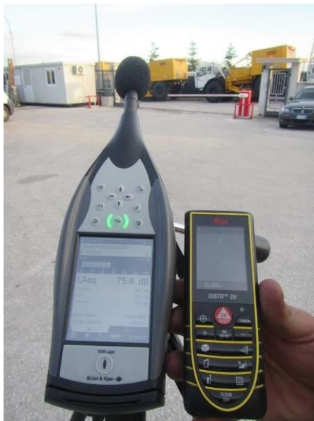
Misura trasversale allineamento vibratori: 30 m - 75.8 dB
