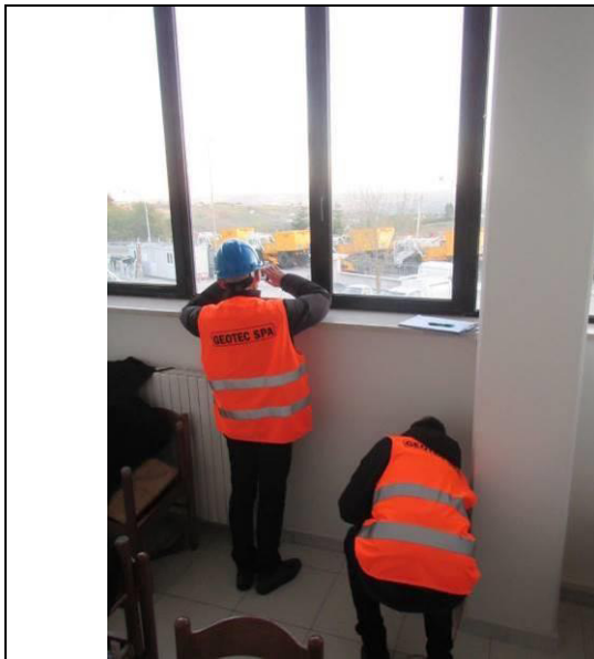
Misura trasversale allineamento vibratori: 10 m – 1^ PIANO EDIFICIO (PAVIMENTO PIASTRELLATO)
