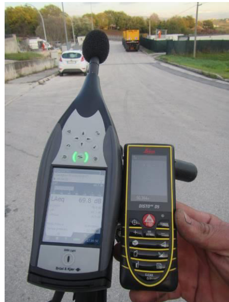
Misura longitudinale allineamento vibratori: 50 m - 69.9 dB
