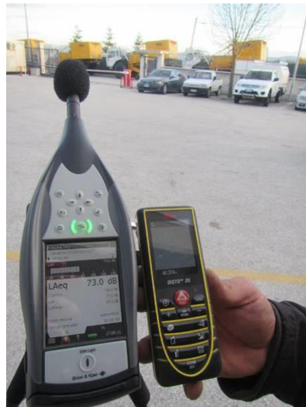
Misura trasversale allineamento vibratori: 40 m - 73.0 dB
