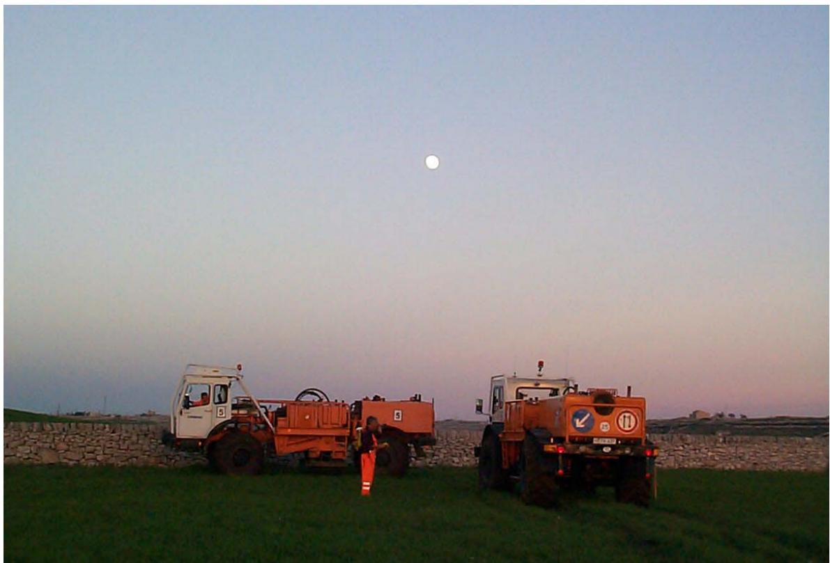
Figura 7 – Passaggio dei Vibroseis su area agricola. Evidenze del terreno compattato dopo il transito dei suddetti mezzi
