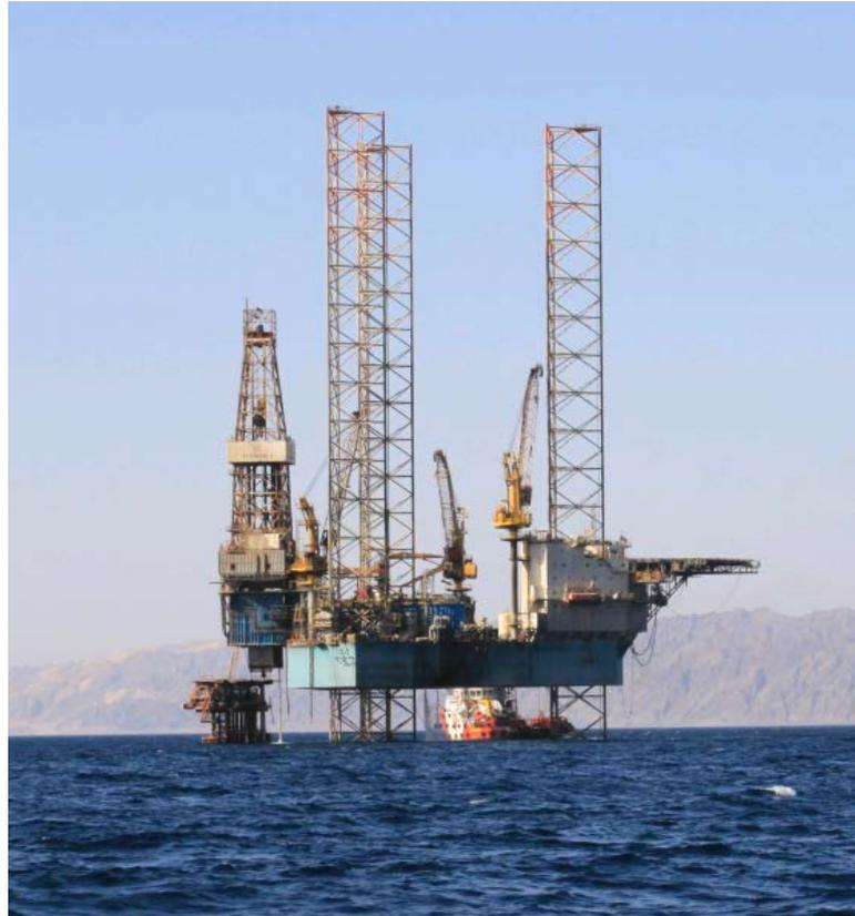
**Figura 8.b: Esempio di Impianto di perforazione Jack Up**
