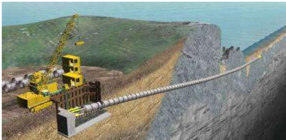
Figura 15-1- Schema tipico di un microtunnel per approdo marino
