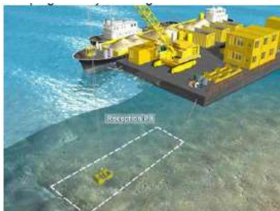
*Figura 15-16- TBM allo sbocco in seguito alla rimozione del deposito marino.*
