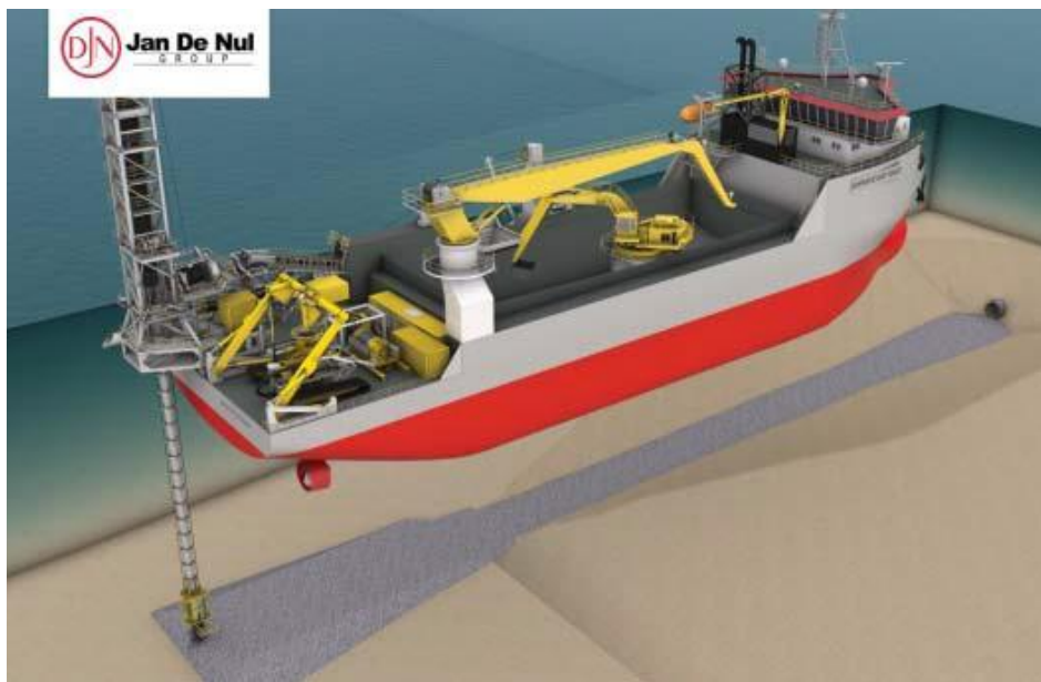
Figura 3-30: Riempimento del terrapieno da parte della nave
