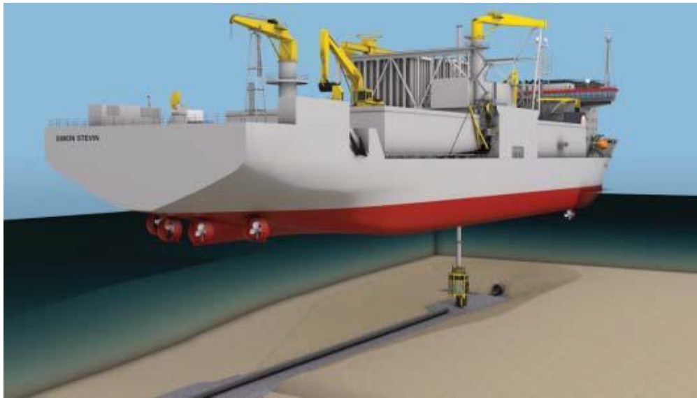
Figura 3-33: Installazione della ghiaia con (FPV) 'Simon Stevin'
