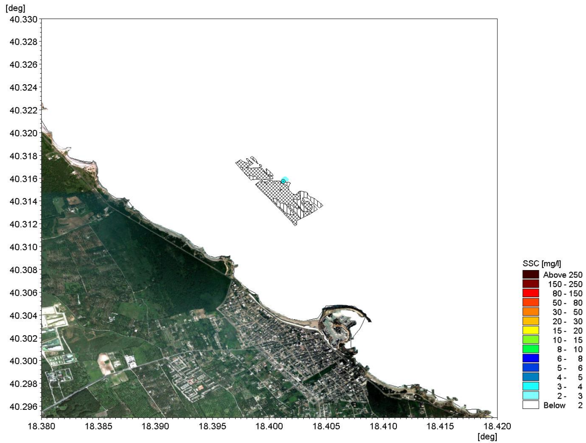
Figura 5-4 Dragaggio: concentrazione massima alla profondità intermedia su base annuale
