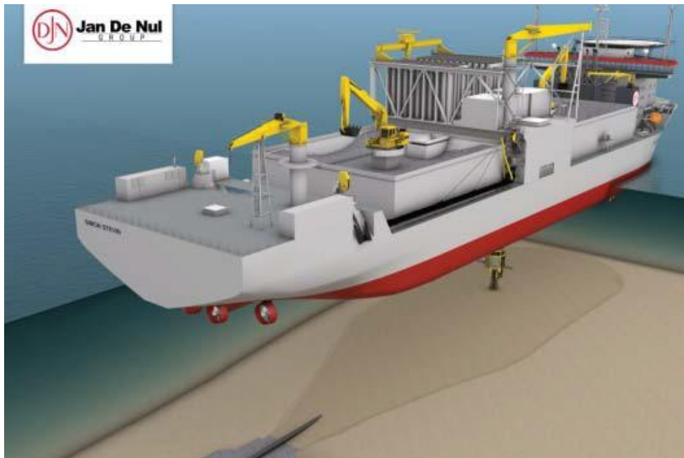
Figura 3-34: Installazione del materiale precedentemente dragato all'interno della trincea con l'utilizzo del FPV
