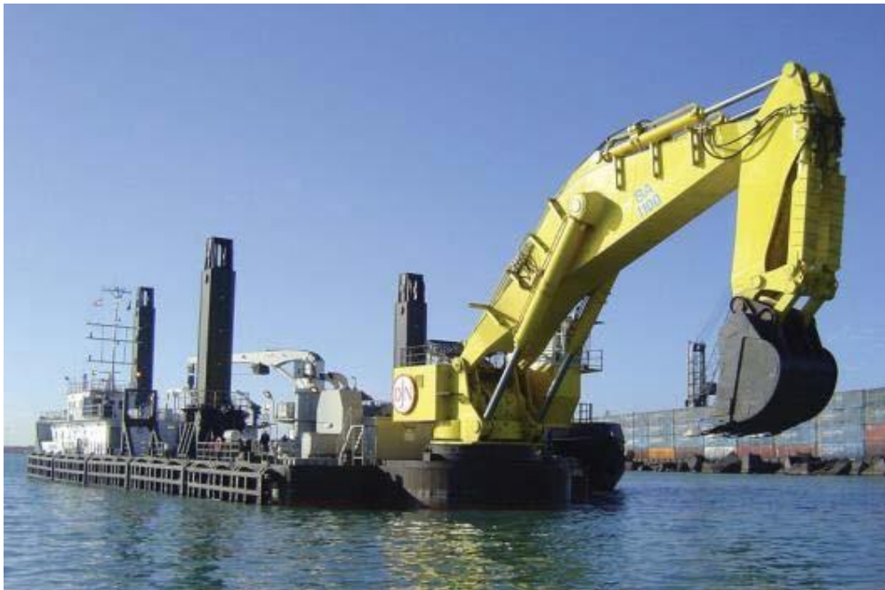
Figura 3-22: Tipica Dragha Escavatrice Backhoe Dredger BHD 'Mimar Sinan'
