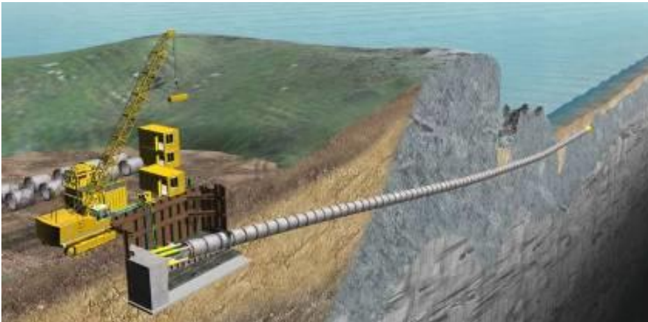
Figura 3-9 Schema tipico di un Microtunnel per approdo marino
