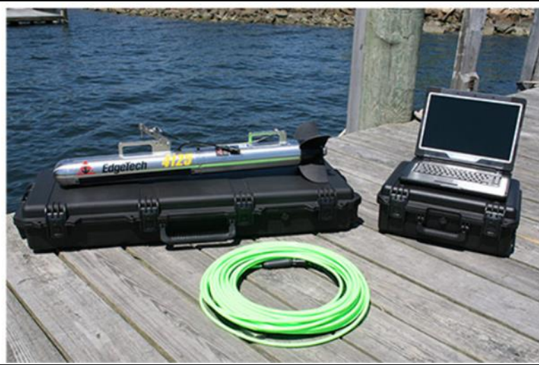
Figura 1.2 Il sistema side scan sonar impiegato per i rilievi
