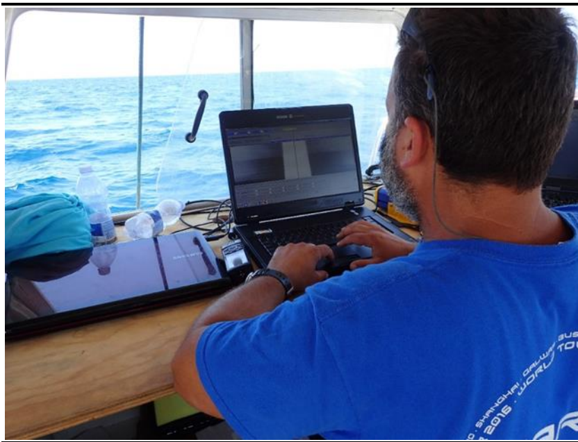
Figura 1.4 L'operatore monitorizza il segnale del side scan sonar proveniente dal fondale
