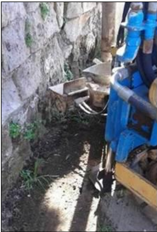
Figura 6-2: Sondaggio effettuato mediante perforazione a carotaggio.
