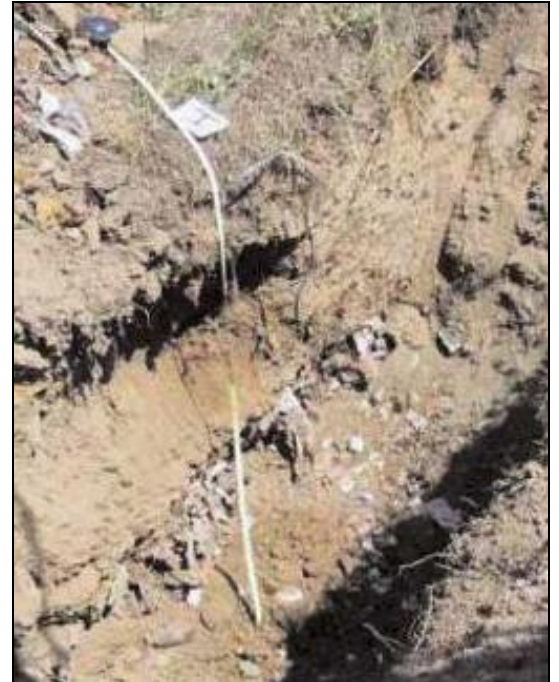
Figura 6-1: Scavo realizzato con pala meccanica. Consente di osservare la sequenza litologica sulle pareti dello scavo stesso e di verificare la presenza di una falda superficiale.
