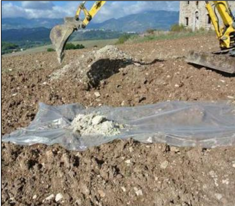
Figura 6-1: Scavo realizzato con pala meccanica. Consente di osservare la sequenza litologica sulle pareti dello scavo stesso e di verificare la presenza di una falda superficiale.
