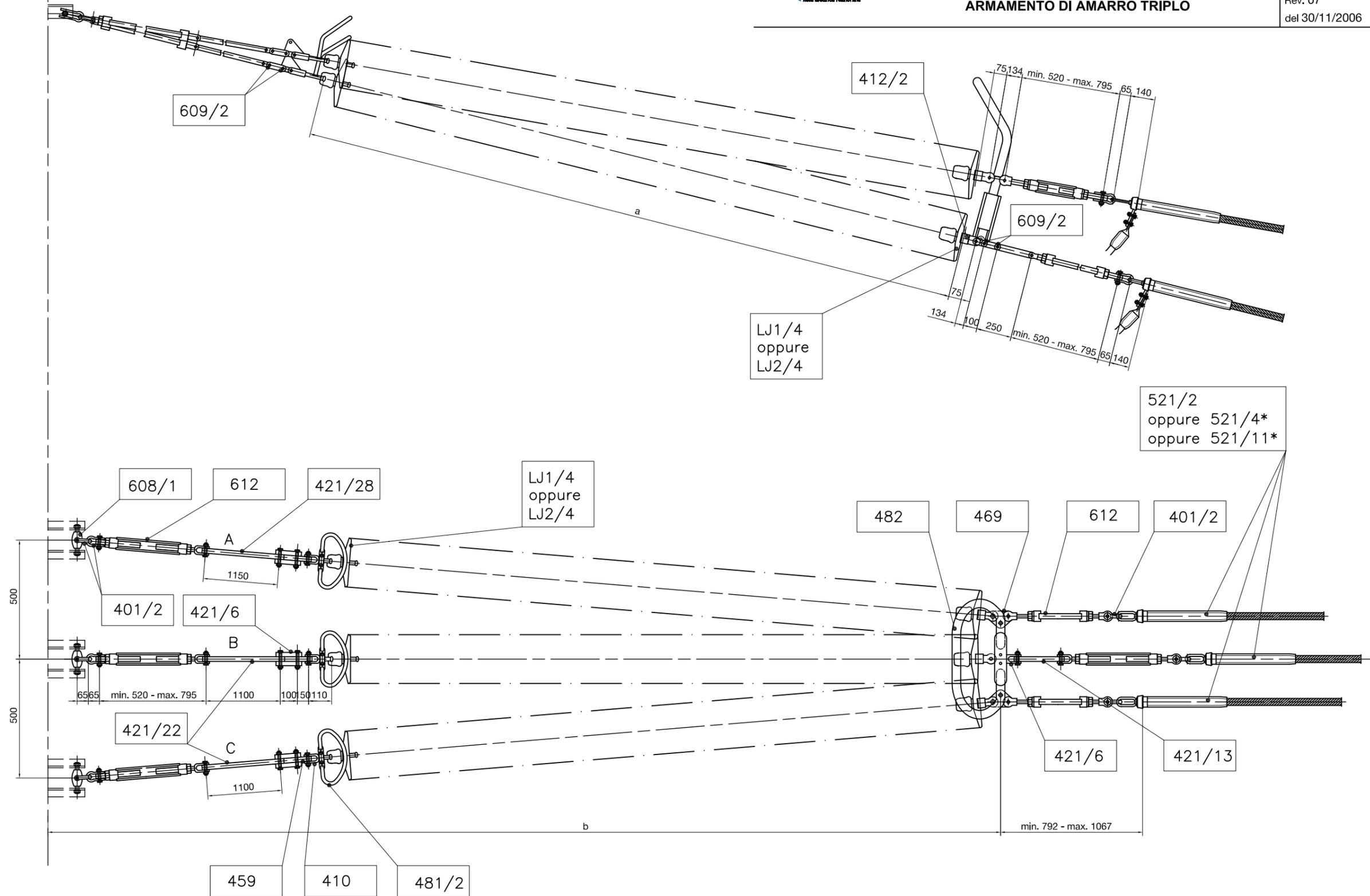
\* La morsa di amarro impiegata sul sostegno capolinea per il passaggio da fascio trinato Ø 31,5 mm a:
