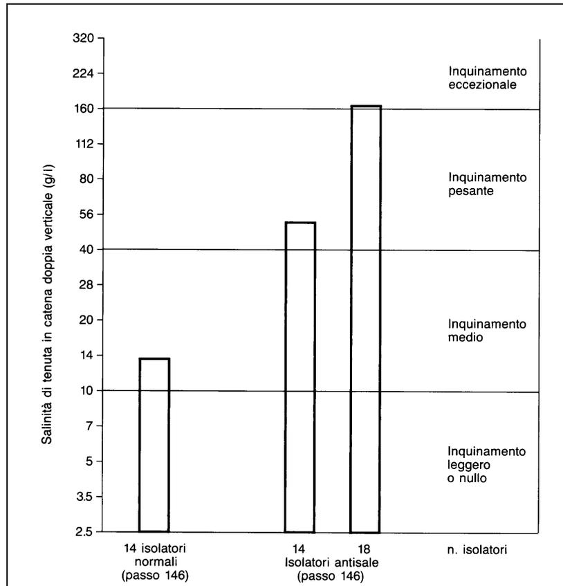
Per le linee che attraversano zone prive di inquinamento atmosferico è previsto l'impiego di catene (di sospensione o di amarro) composto da 14 elementi di tipo "normale".
