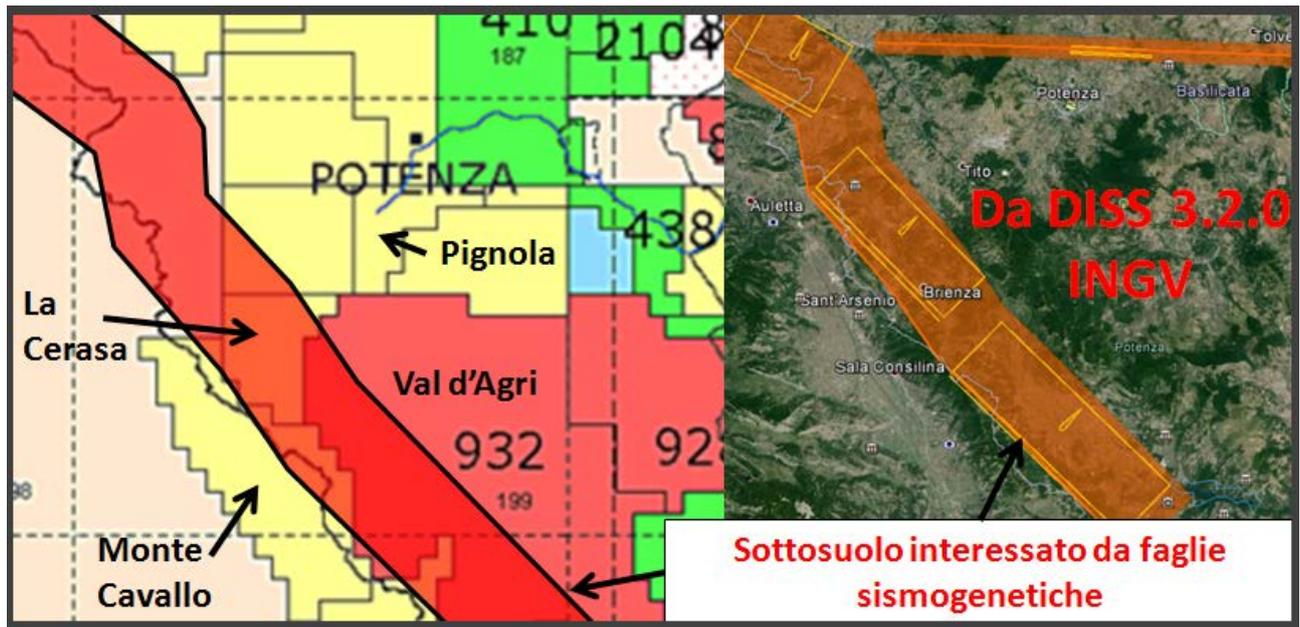
Figura 4: le faglie sismogenetiche che interessano il sottosuolo delle istanze Monte Cavallo e La Cerasa secondo DISS 3.2.0 di INGV. I riquadri **con linea gialla nella immagine a destra** individuano faglie sismogenetiche individuali che hanno originato i terremoti del 1561 (riquadro in alto nell'immagine a destra) e 1857 (**riquadri al centro e a sinistra, nell'immagine a destra, che interessano l'istanza La Cerasa**).
