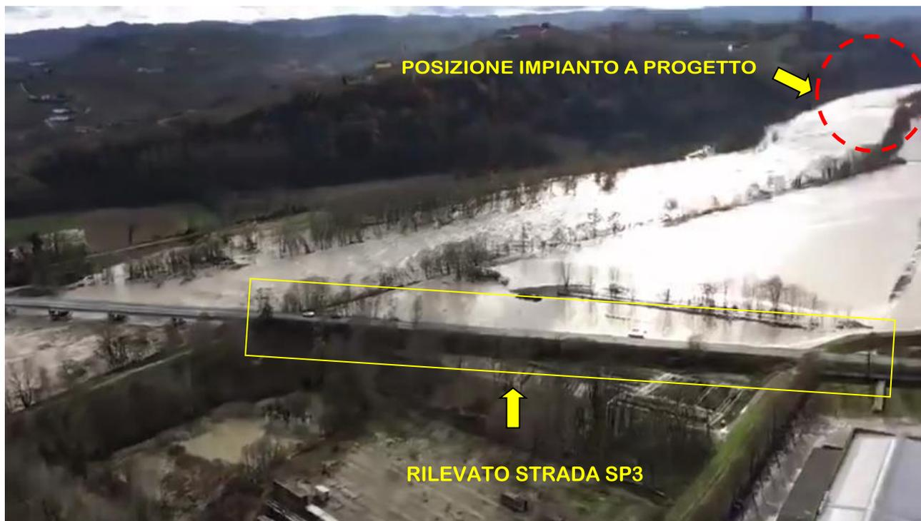
Fig. 2. - Evidenza degli elementi infrastrutturali esistenti che condizionano il deflusso delle acque a valle dell'impianto in corrispondenza Strada SP3 "Castagnito-Neive". – situazione durante l'evento alluvionale del 25 Novembre 2016
