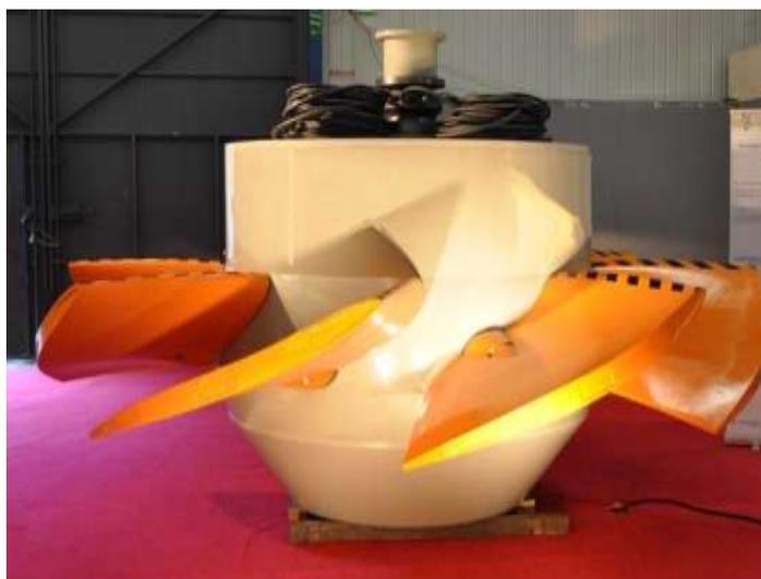
Fig. 4 Immagini della girante di una VLH
