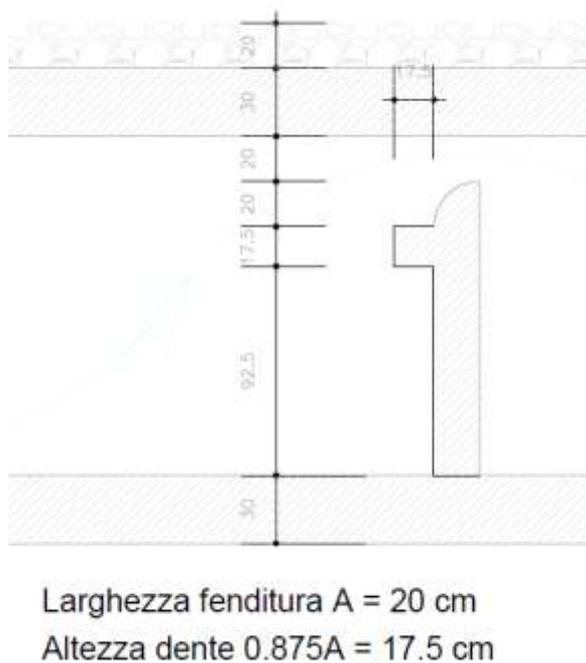
Fig. 6 Pianta e dimensioni setto tipo Dimensionamento passaggio a slot verticali
