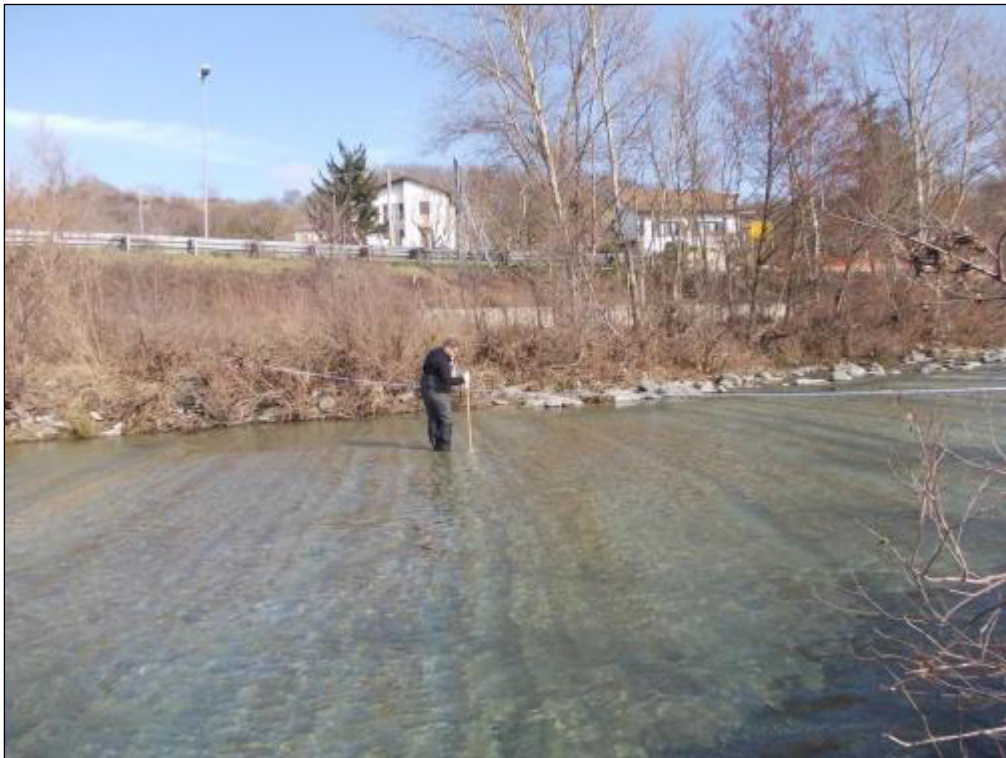
Foto 3 – Misurazione delle portate nella stazione T-GA-020 del Torrente Lemme (Febbraio 2016)
