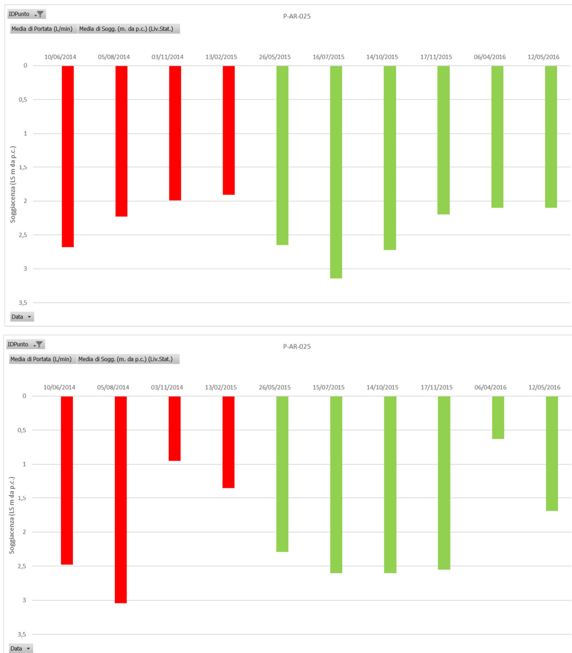
Figura 6.12 – Grafici riportanti i dati di falda dei punti di misura associati alla WBS GA1U nel corso delle diverse campagne di misura realizzate (in rosso le campagne di Ante Operam e in verde quelle di Corso d'Opera).
