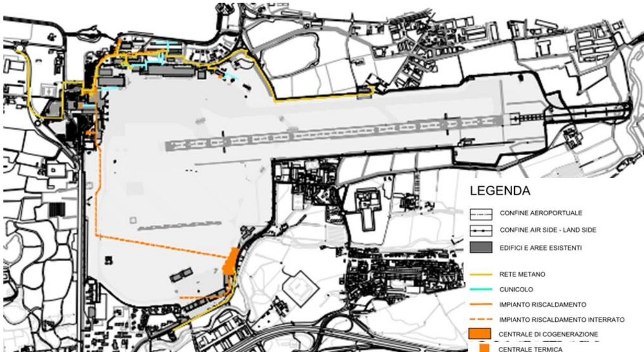
Figura 2-19 Rete rinfrescamento/riscaldamento e rete metano (Fonte: Masterplan, Tav. MP016)
