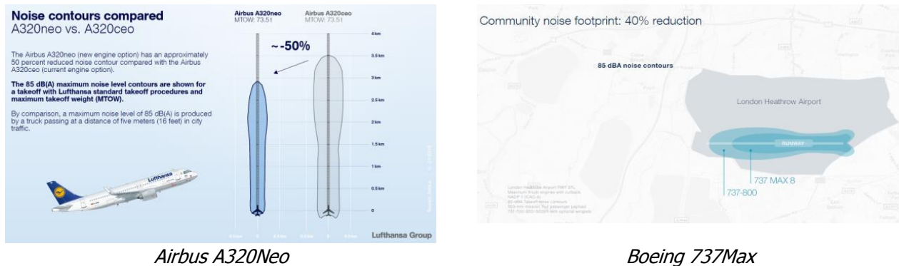
Figura 7-10 Riduzione dell'impronta acustica Airbus A320Neo e Boeing 737Max rispetto ai precedenti rispettivi modelli dichiarata dai costruttori
