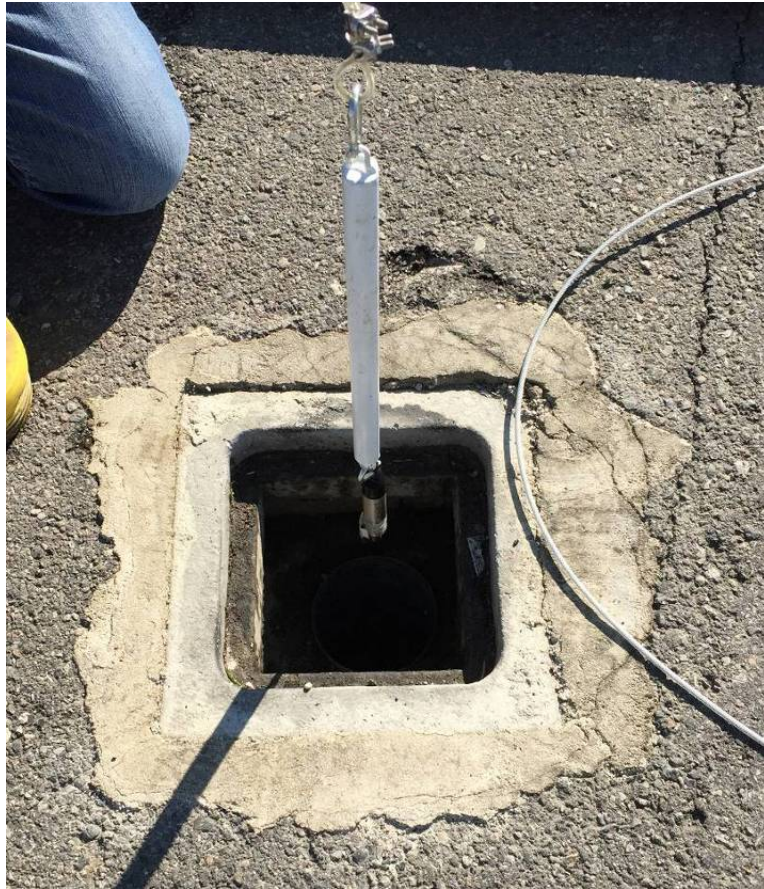
Figura 40. Inserimento del datalogger all'interno di un piezometro.
