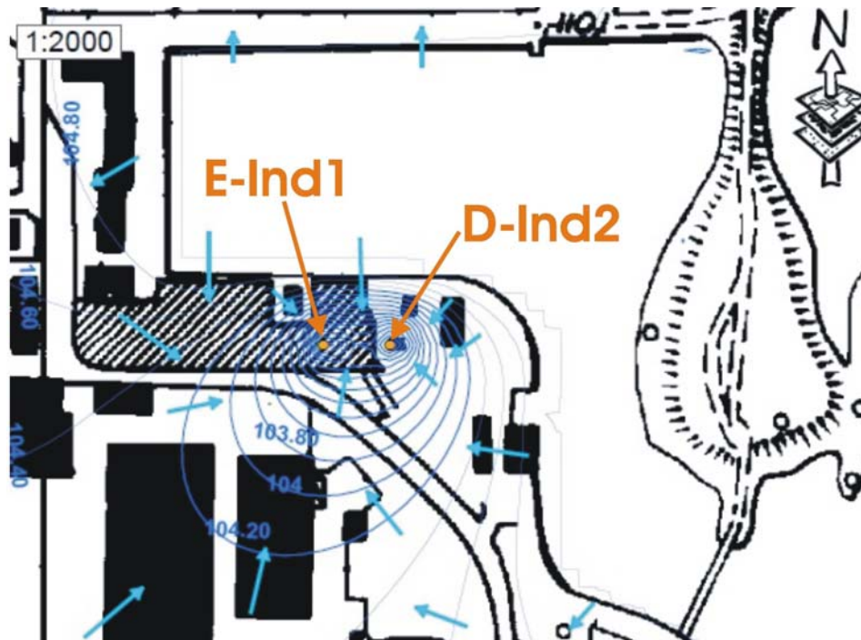
Figura 72. Piezometri dinamica della falda superficiale secondo la modellazione di Ummarino et al. (2008), nei pressi dei pozzi E-Ind1 e D-Ind2 (da Ummarino et al. 2008 - Tavola 4b, modificata).
