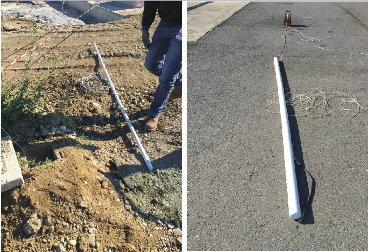
Figura 39. Bailer utilizzati per le prove. A sinistra quello utilizzato per i piezometri Pz1a e Pz3a, a destra quello utilizzato per i piezometri S1d, S2d e S3d.
