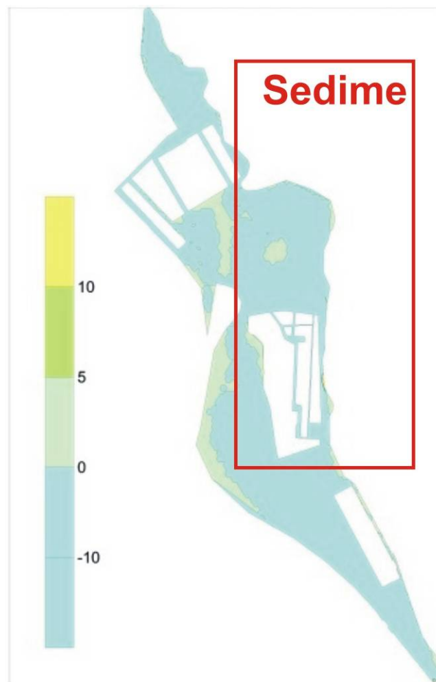
Figura 45. Differenza percentuale tra h/h_{limite} dopo le opere di miglioramento in progetto e h/h_{limite} della situazione attuale, per T_R di 200 anni. Si notano valori negativi che corrisponderebbero a una minore estensione delle aree inondabili.
