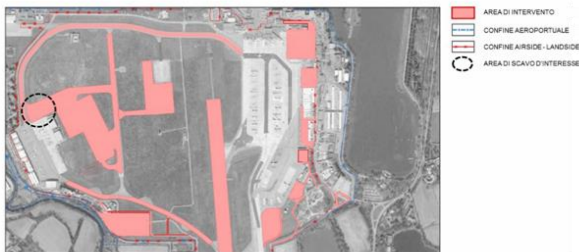
Figura 16, Posizione delle lavorazioni di scavo previste per il settembre 2021 nel cantiere di Linate-Aviazione Generale
