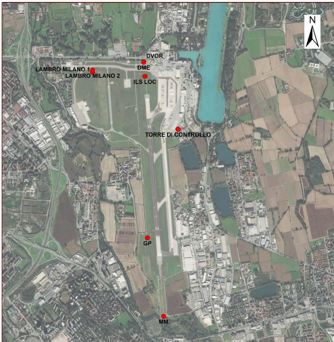
Figura 1, Ubicazione dei principali impianti di ausilio alla navigazione aerea installati nell'area aeroportuale
