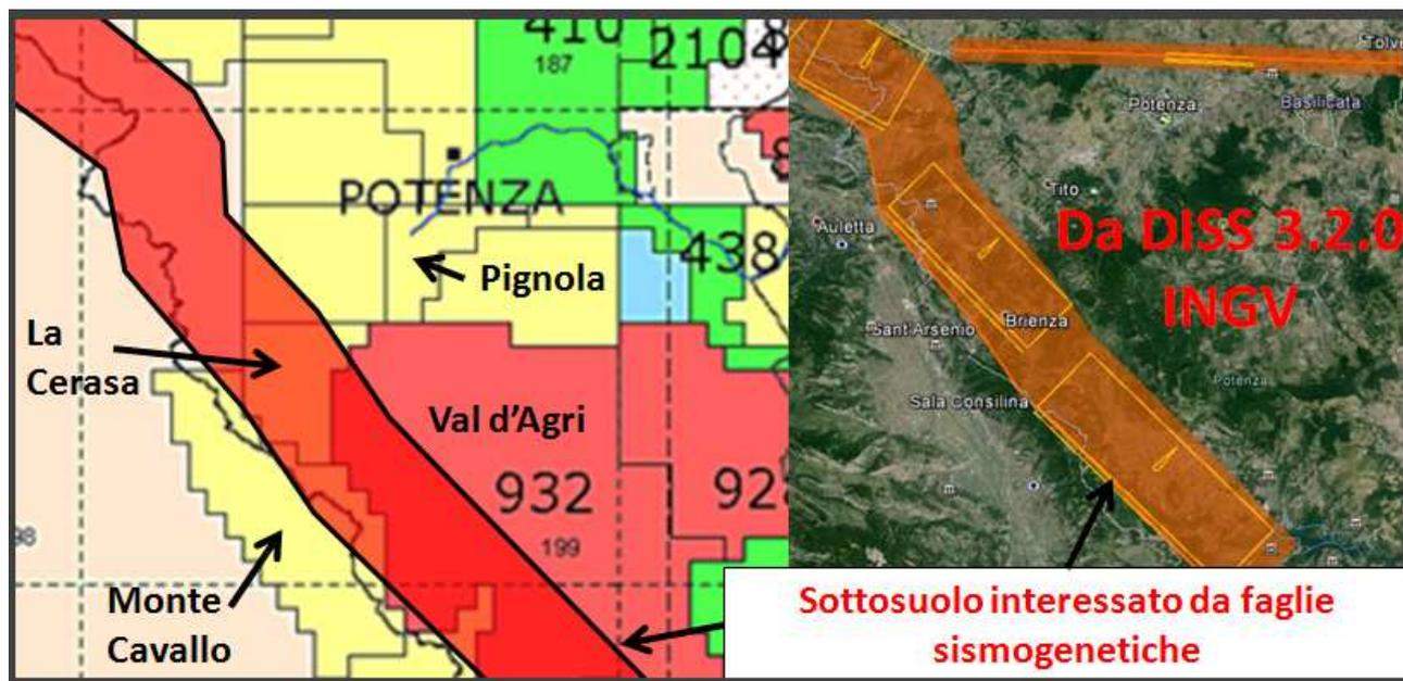
Figura 4: le faglie sismogenetiche che interessano il sottosuolo delle istanze Monte Cavallo e La Cerasa secondo DISS 3.2.0 di INGV. I riquadri **con linea gialla nella immagine a destra** individuano faglie sismogenetiche individuali che hanno originato i terremoti del 1561 (riquadro in alto nell'immagine a destra) e 1857 (**riquadri al centro e a sinistra, nell'immagine a destra, che interessano l'istanza La Cerasa**).
