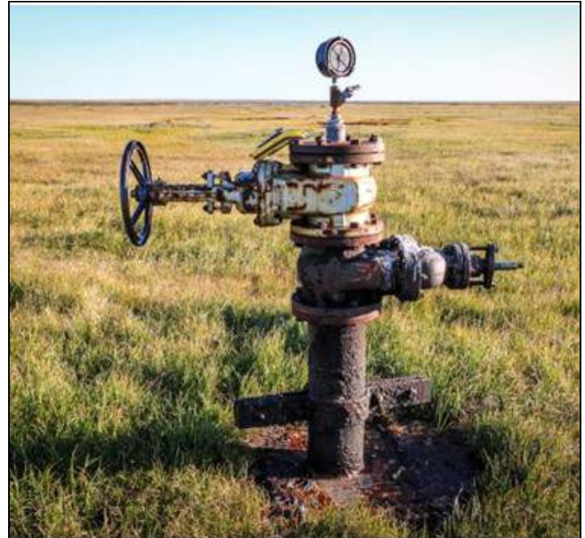
Fig. 24 A,B. Pozzi abbandonati con chiusure metalliche che si stanno arrugginando.
