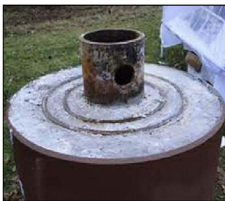
Fig. 29 A,B - A sinistra: sezione di un sistema di tubi cementati tra loro. A destra: modalità di migrazione del gas da un pozzo .
