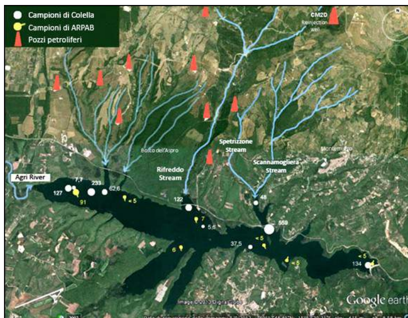
Fig. 15 - Ubicazione dei campioni di sedimenti studiati nell'invaso del Pertusillo, e concentrazioni (in mg/kg) di idrocarburi totali espresse dai numeri accanto ai cerchi, il cui diametro è proporzionale alle concentrazioni. Queste ultime risultano maggiori lungo il margine nord-orientale petrolizzato dell'invaso e alla foce del F. Agri (Colella, 2012, 2013).
