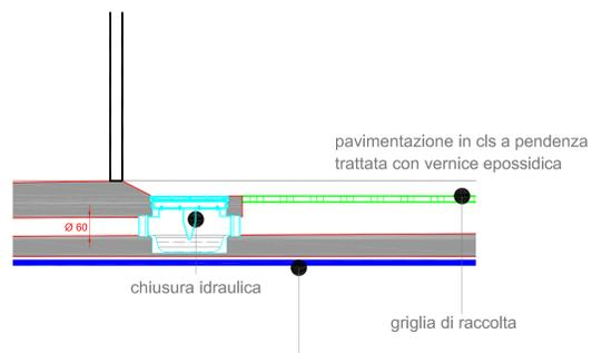
Particolare separazione idraulica
